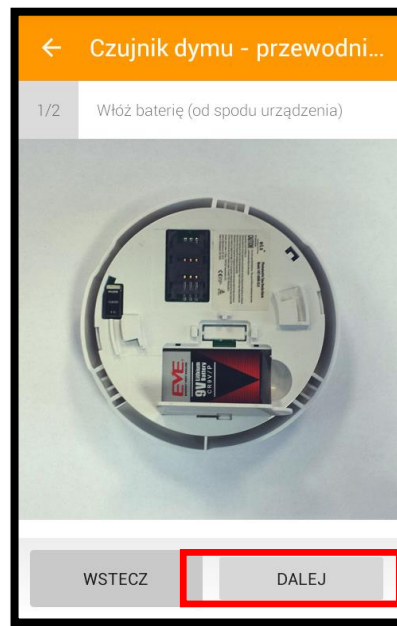
Rys. 8: Włożenie baterii do czujnika
