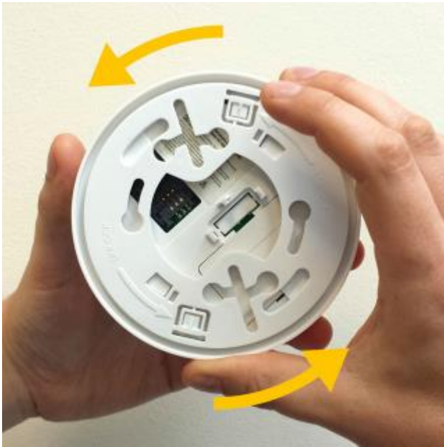
Rys. 2: Demontaż tylnej części czujnika
